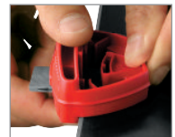
Feilen an den Belagkanten
